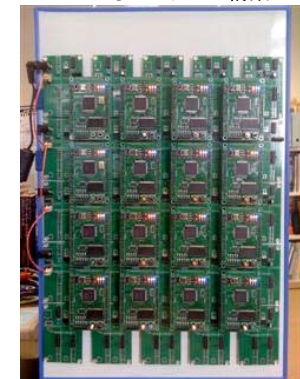
評価のためのFPGAによるシステムの構築
